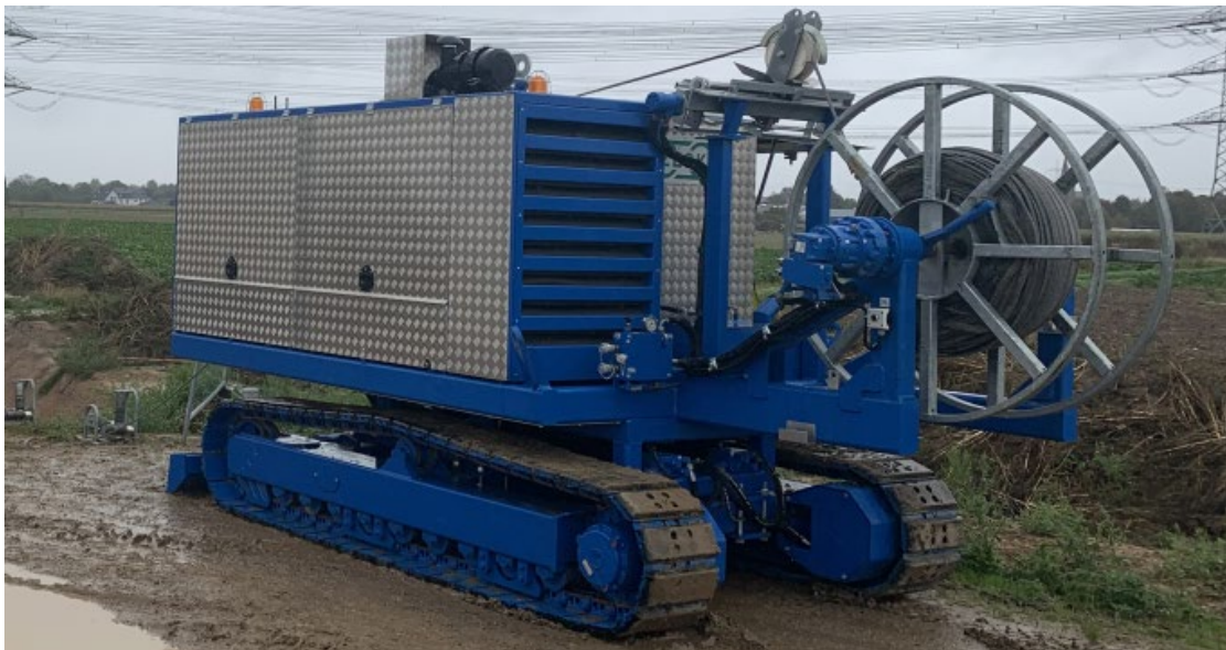
Abb. 2-20: Beispiel für ein Kabelzugerät auf selbstfahrendem Raupenfahrwerk, Quelle: Amprion GmbH
