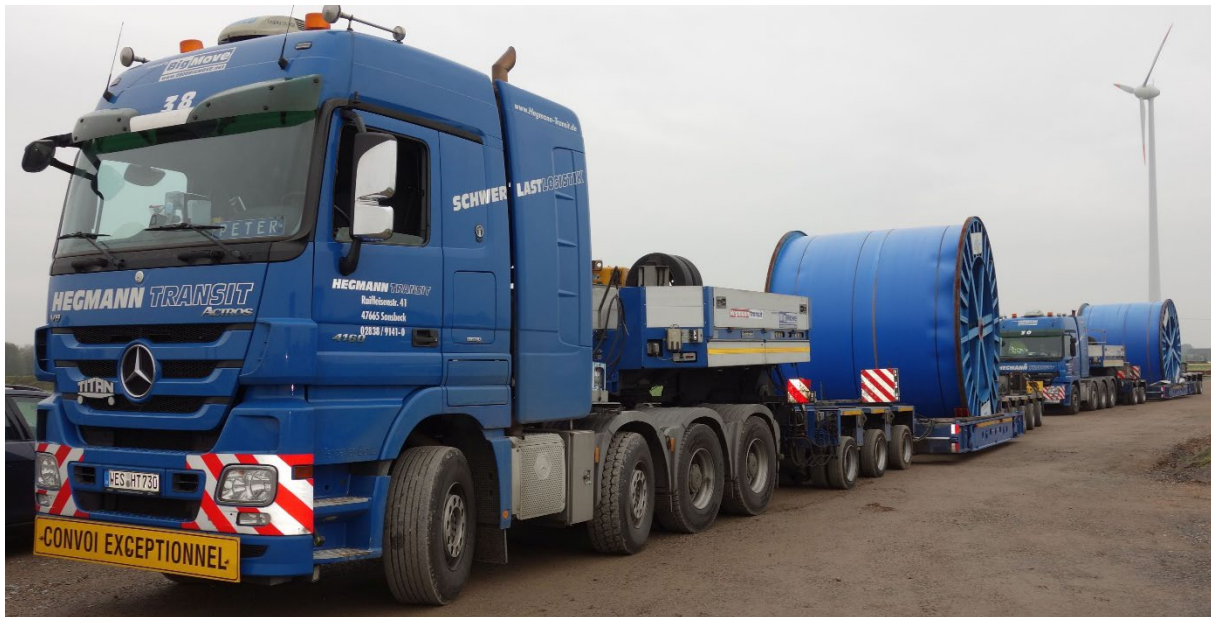
Abb. 2-17: Anlieferung der Kabelspulen, Quelle: Amprion GmbH
