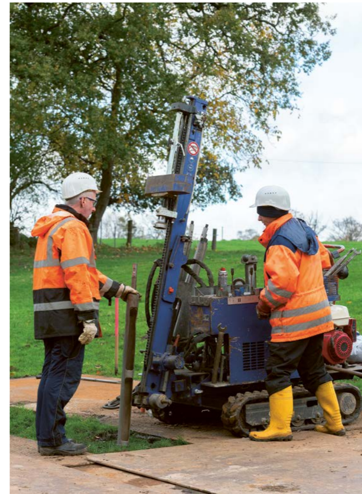
Bei der Kleinrammbohrung kommt ein Hohlgestänge zum Einsatz – das Ziel: Bodenproben entnehmen
