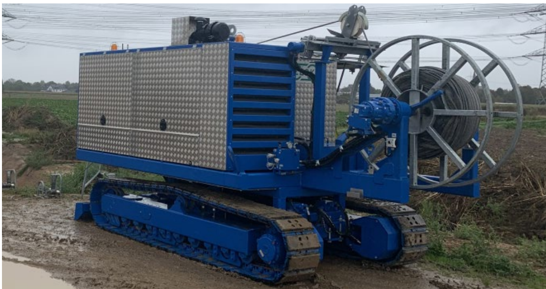
Abb. 2-23: Beispiel für ein Kabelzugerät auf selbstfahrendem Raupenfahrwerk, Quelle: Amprion GmbH
