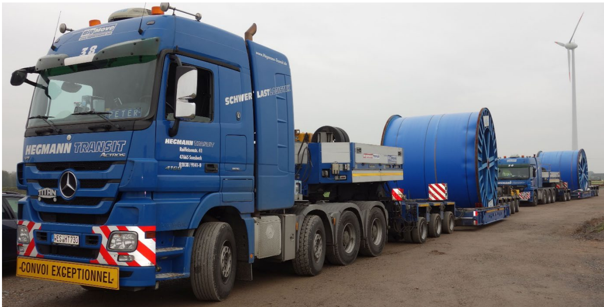
Abb. 2-17: Anlieferung der Kabelspulen, Quelle: Amprion GmbH
